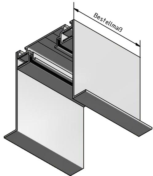
MP-80-V1 mit eingebauter Kassette
